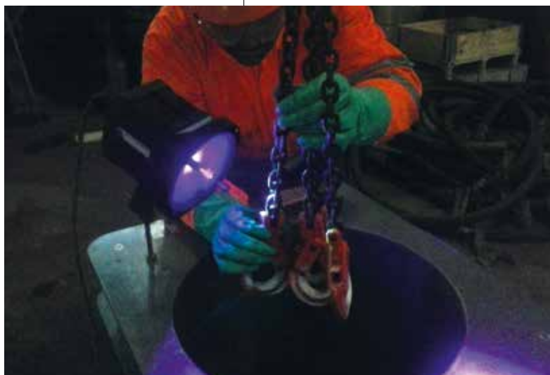
Controllo magnetoscopico, coil con bobina elettromagnetica
