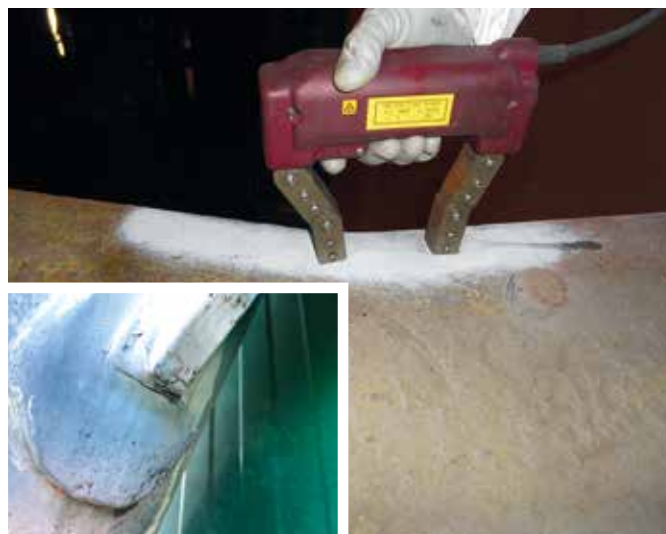
Controllo magnetoscopico, gioco elettromagnetico
