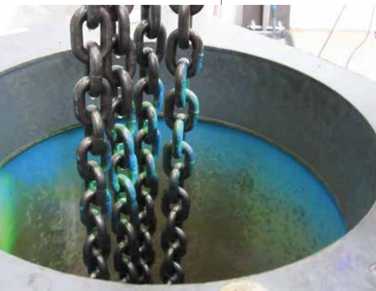
Camera oscura per controlli con liquidi fluorescenti
